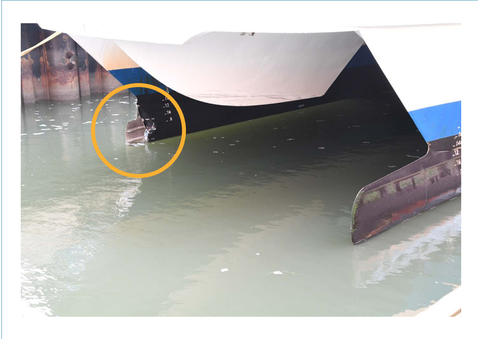
Figuur 4: Schade aan de stuurboord bulbstevan van de snelboot. De punt van de steven mist. (Bron: Politie)
