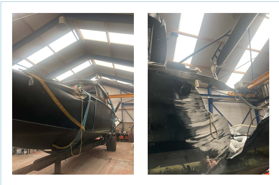
Figuur 5: Beeld van de opgelopen schade aan de watertaxi door de impact van de aanvaring.
