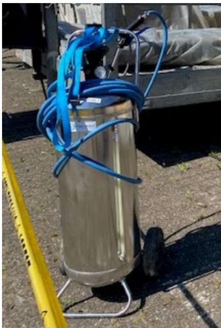
Foto 1: Foamer (reservoir en spuitlans) die gebruikt werd tijdens het schuimen
