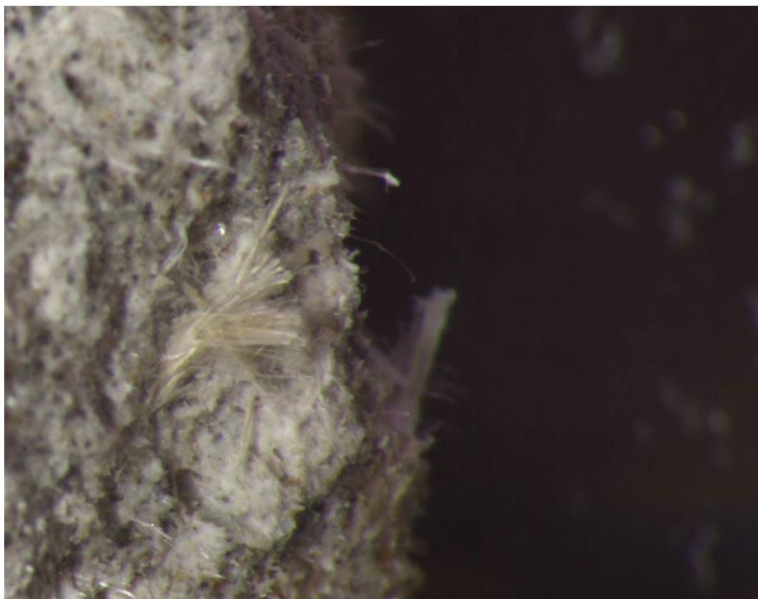
Foto B5-1: Voorbeeld van amosiet vezelbundel aangetroffen in materiaalmonster asbestcement (lichtmicroscopie)
