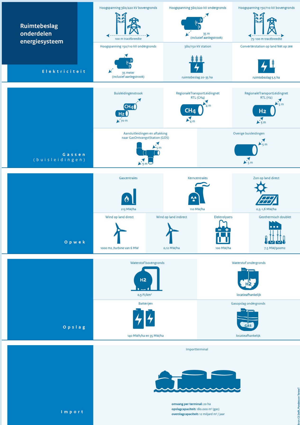
Figuur 3: Aannames ruimtebeslag per onderdeel van het energiesysteem 13
