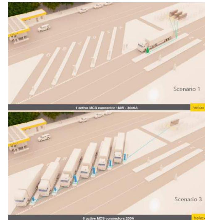
Figuur 5.6: Schematisch overzicht van modulaair opgebouwde laadinfrastructuur [85]
