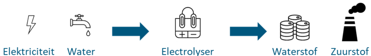
Figuur 2-1: Schematische weergave waterstofproductie door middel van elektrolyse.
