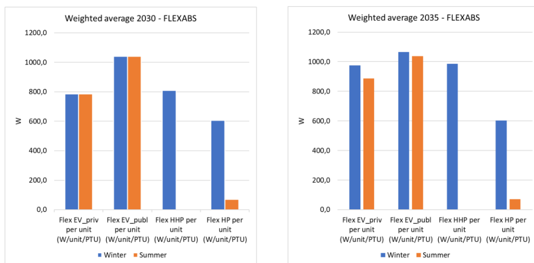
Figuur 2.3: FLEXABS-metriek in 2030 (links) en 2035 (rechts) voor alle apparaat typen in winter (blauw) en zomer (oranje).
